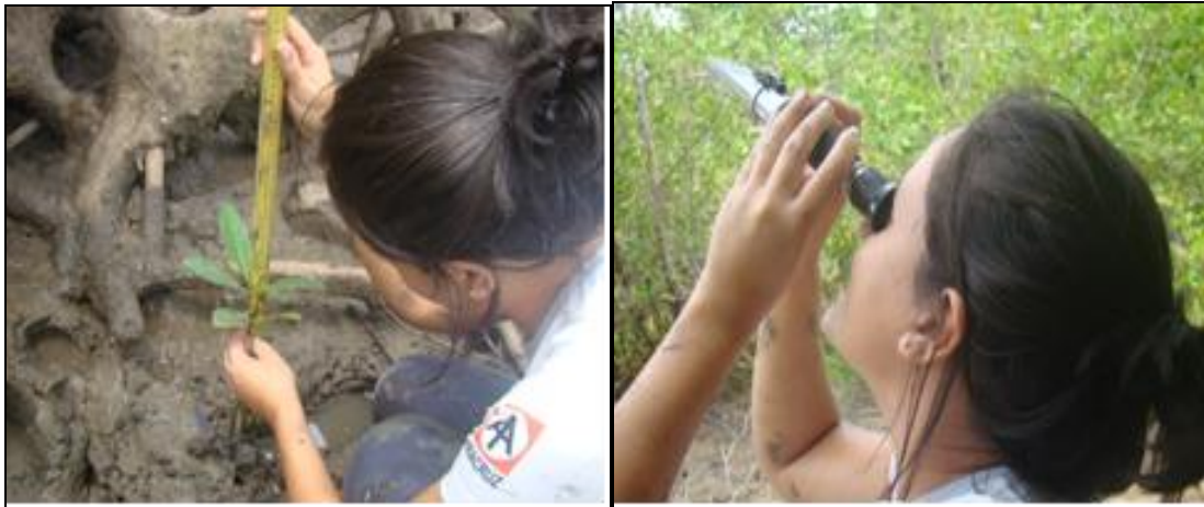
Figura 2. (a) Medição em campo da altura de plântula de Rhizophora mangle presente em uma das áreas de estudo (b) e obtenção da salinidade a partir da análise da água intersticial do bosque utilizando o refratômetro óptico. Fonte: GEMA/CEUNES.
