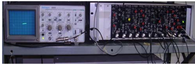
Figura 1 – À esquerda observa-se o osciloscópio e à direita o amplificador e os filtros. Estes equipamentos constituem uma parte do sistema integrado para captação e digitalização do registro eletroencefalográfico.
