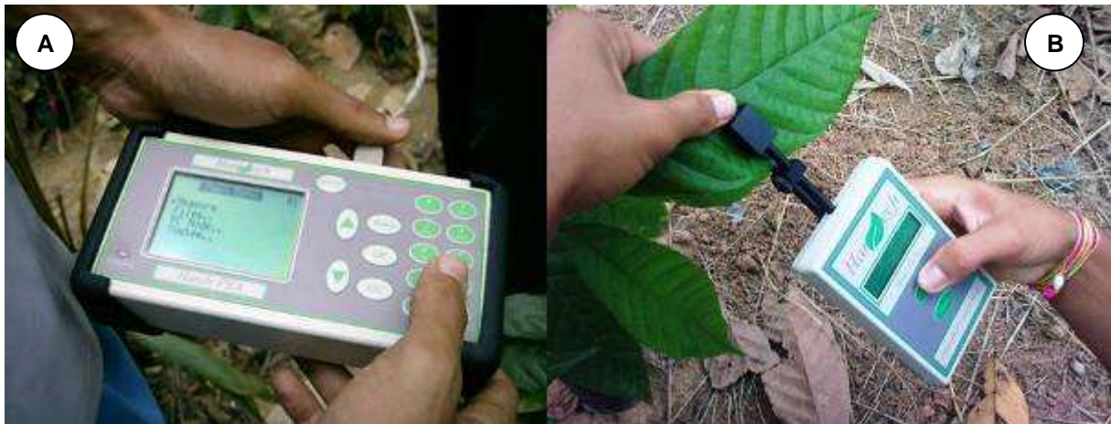
Figura 3. Avaliação da fluorescência da clorofila a, com Handy PEA (A) e do teor de clorofila total, com clorofilômetro (B).
