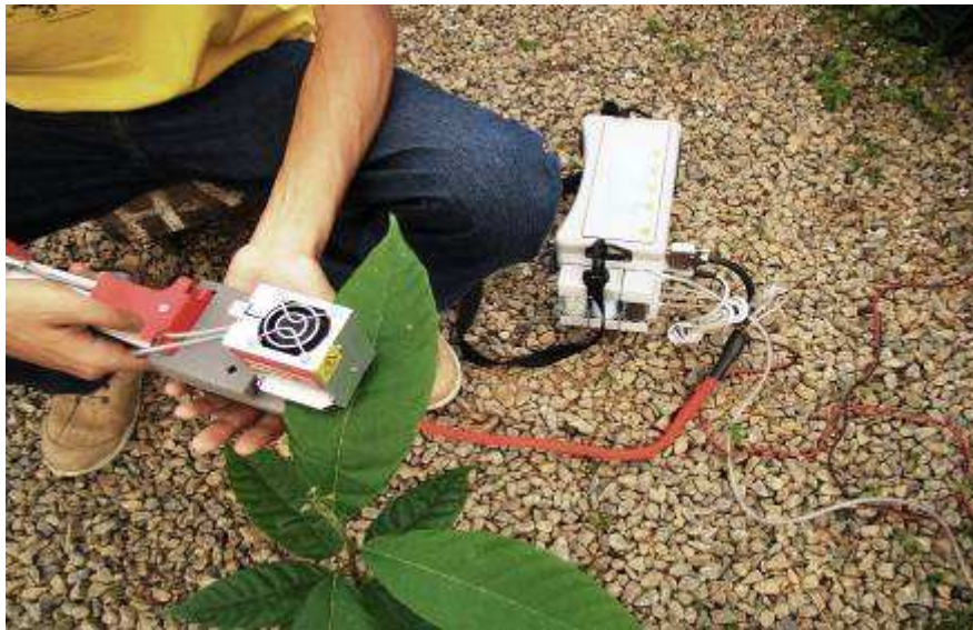
Figura 6. Avaliação das trocas gasosas foliares em casa de vegetação efetuadas com medidor portátil de fotossíntese.
